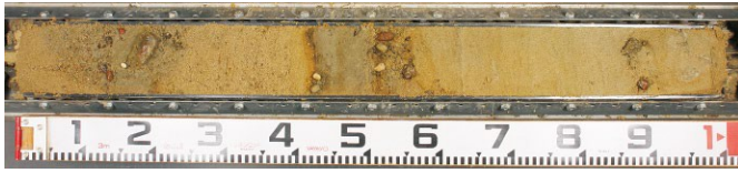
Bild 3: Bohrkern mit kleinräumig wechselnden Bodenarten Figure 3: Core sample small scale structured with difficult soil groups
