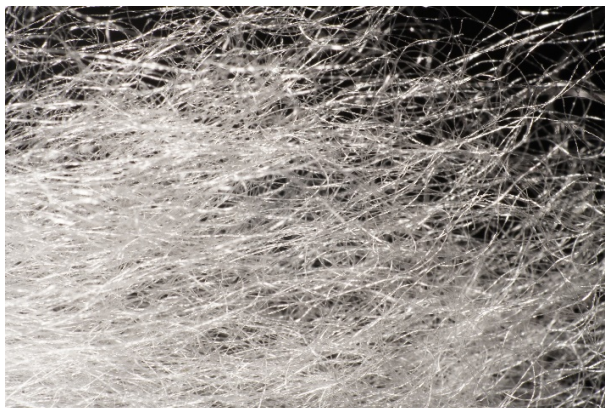
Abbildung 4: Stapelfasern als Rohstoff für das zu 100-prozent biologisch abbaubare Geotextil Secutex® Green
