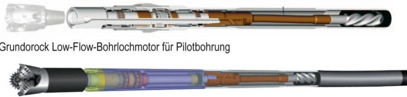
Bild 3 und 4: Hochleistungsfähiger HDD-Mudmotor „Grundorock“ mit Darstellung des Innenlebens (Meißelkopf, Lagerstock, Gelenkstück und Rotor-Stator-Sektion) und typischer Einsatzfall eines solchen Mudmotors
