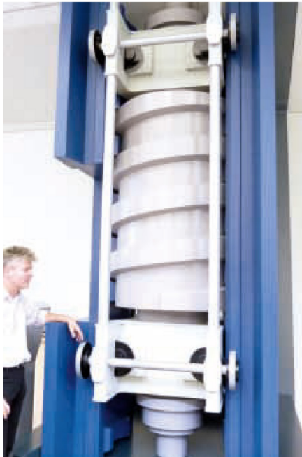
Abb. 5: Modell eines Abschnittes einer Mutterbackensäule (blau) mit Drehriegel (grau) im Maßstab 1:1 (Foto: R. Bischof)
