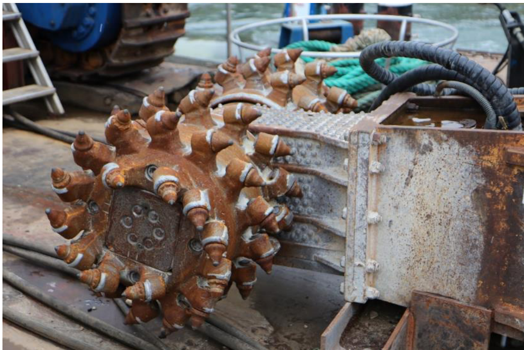
Abb.: Fräskopf zum Felsabtrag (Quelle: BAW).
