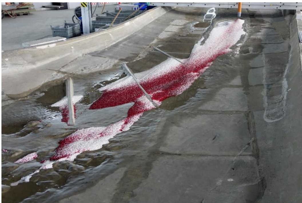
Abb.: Umlenkung des Geschiebetransportpfades durch Grundschwellen (Gegenständlicher Modellversuch der BAW).
