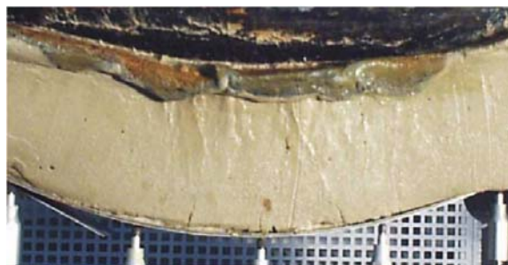
Bild 5: Colcredur im Biegeversuch zur Prüfung der Flexibilität
