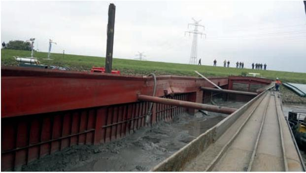
Abb. 9: entladener und leergepumpter Schiffskörper
