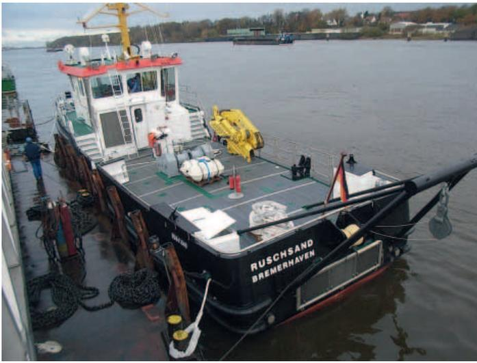
Abb. 7: Kran, Kettensliphaken, Heckaussetzvorrichtung für Unterwasserarbeitsgeräte, Seilführungsrolle achtern
