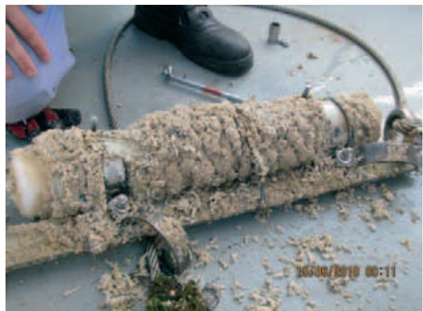
Abb. 5: Stark mit Seepocken bewachsener Klickdetektor
