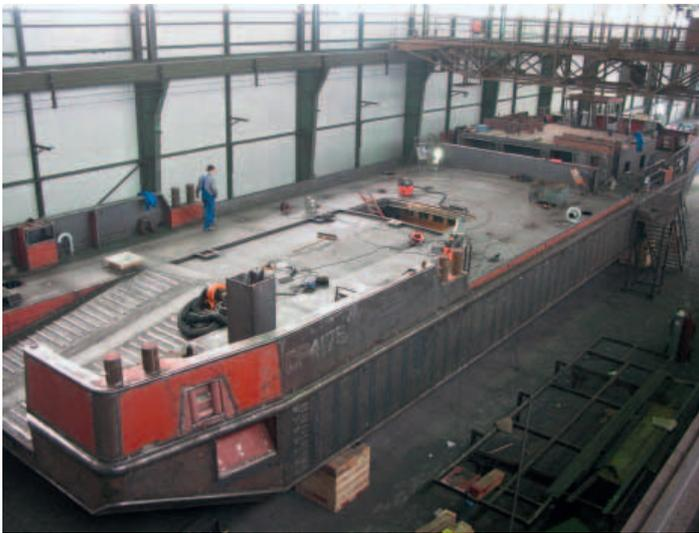
Abb. 8: Decksprahm im Bau
