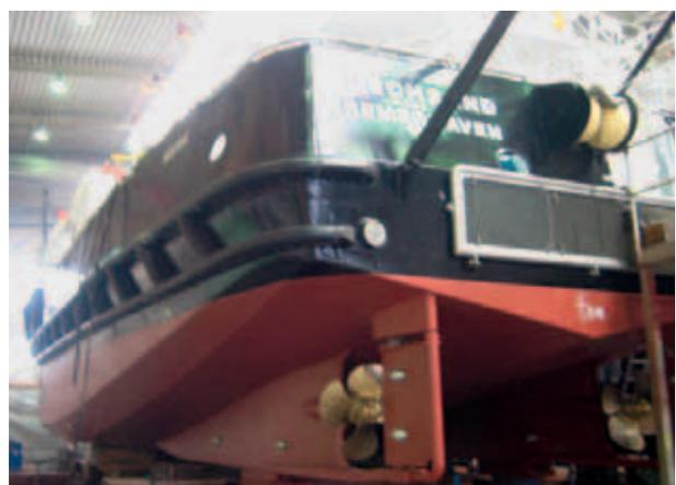
Abb. 5: Doppelmotoren-Zweiwellenanlage
