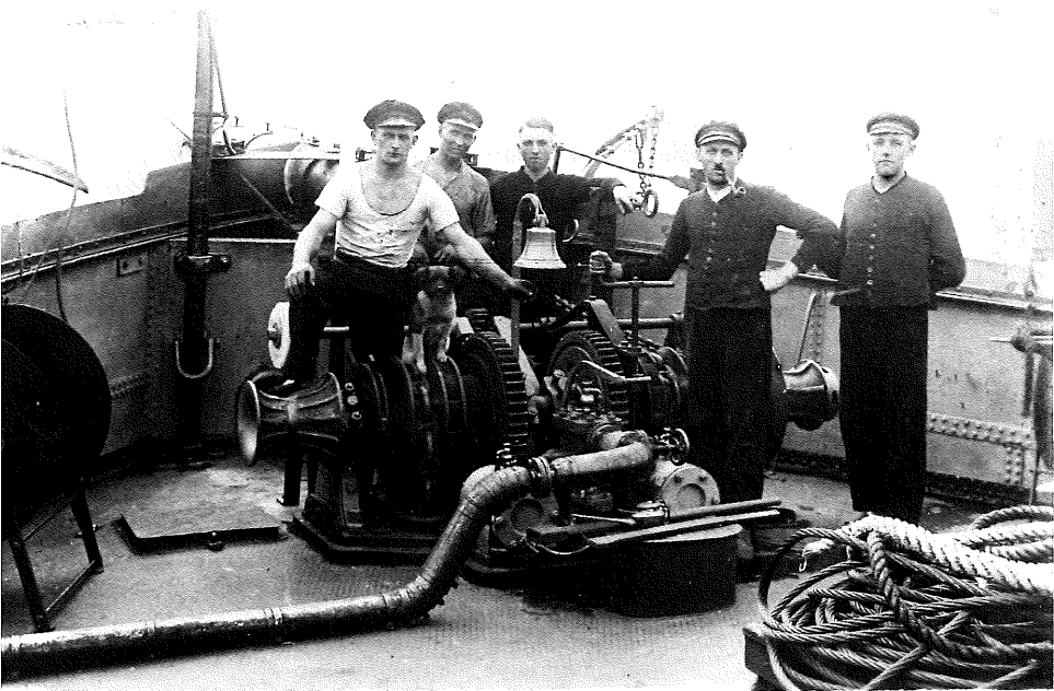
Es war einmal ... Besatzungsmitglieder eines Dampfschleppers an der Dampfankerwinde eines Räderbootes
