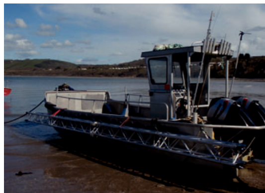
Abb. 1: Anbringung der Vierpunktraverse am Schiff
