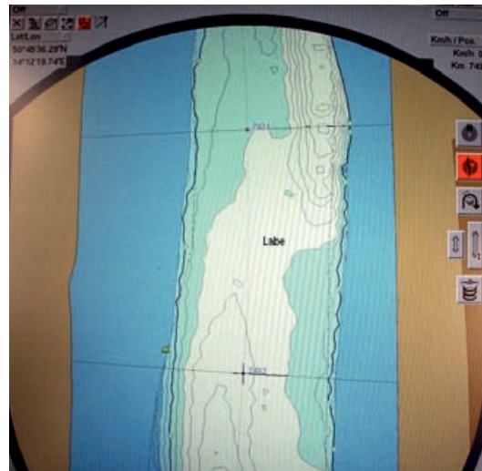
Abb. 4: Elektronische Binnengewässerkarten (IENC) zeigen die Wassertiefen in Abhängigkeit des aktuellen Pegelstands. Als Datengrundlage dienen die digitalen Geländemodelle aus der Fächerlotvermessung und die modellierten Pegelstände
