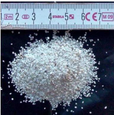
Bild 2: Sand S40T, D^*_{50} = \text{rd. } 19 , d_{50} = 0,82 \text{ mm}
