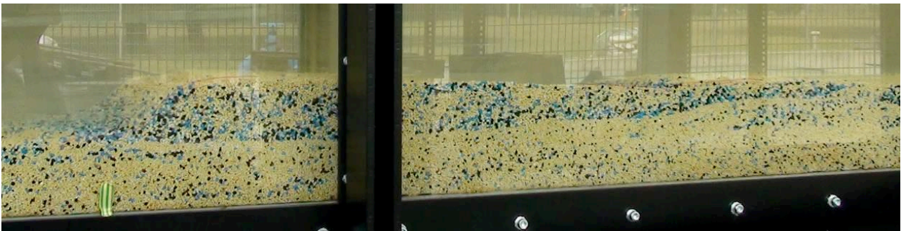
Bild 5: Transportkörper aus einer Kunststoffgranulatsieblinie.
