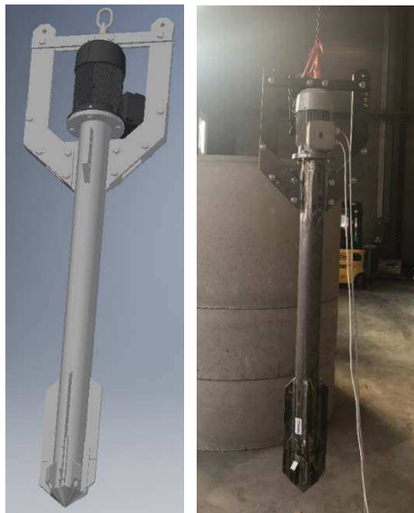
Abbildung 2: Modelltiefenrüttler FH Erfurt
