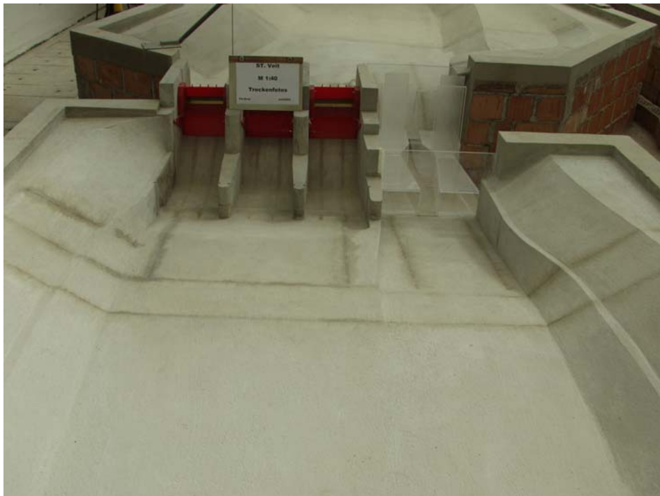
Abbildung 3: Modellversuch KW St. Veit; Ansicht vom Unterwasser
