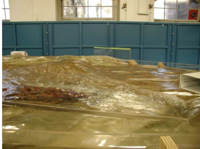
Abbildung 10 Übergang vom schießenden zum strömenden Abfluss beim Eintritt in den Knick
