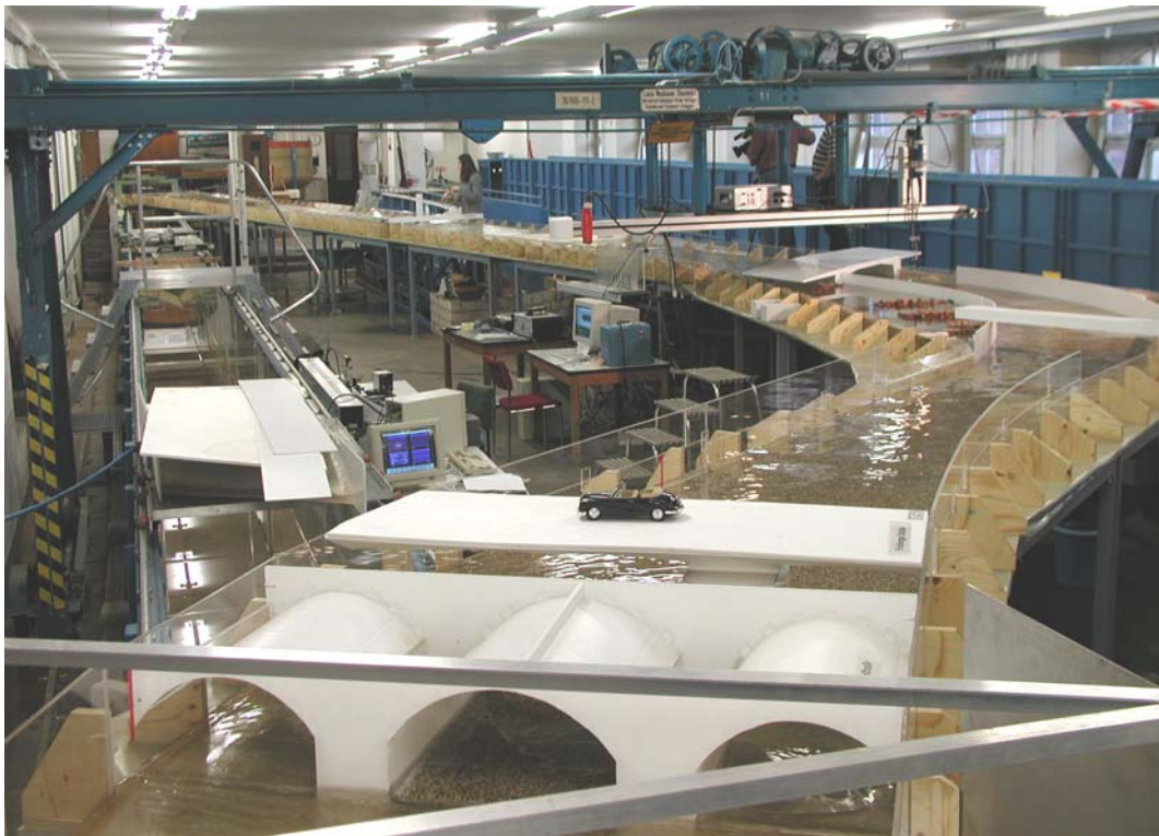
Abbildung 2 Modell „Weißeritzknick“ im Hubert-Engels-Labor
