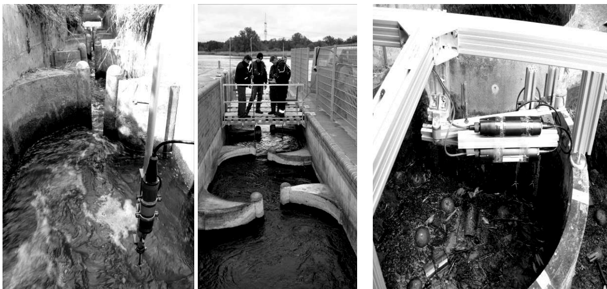
Abbildung 6: Messwertaufnahme, links: FAA Rothemühle, Becken B4; mittig: FAA Bahnitz, Messung von Arbeitspodest über Becken B3; rechts: FAA Höxter mittels Hilfsgerüst und Dreharm im Becken B4
