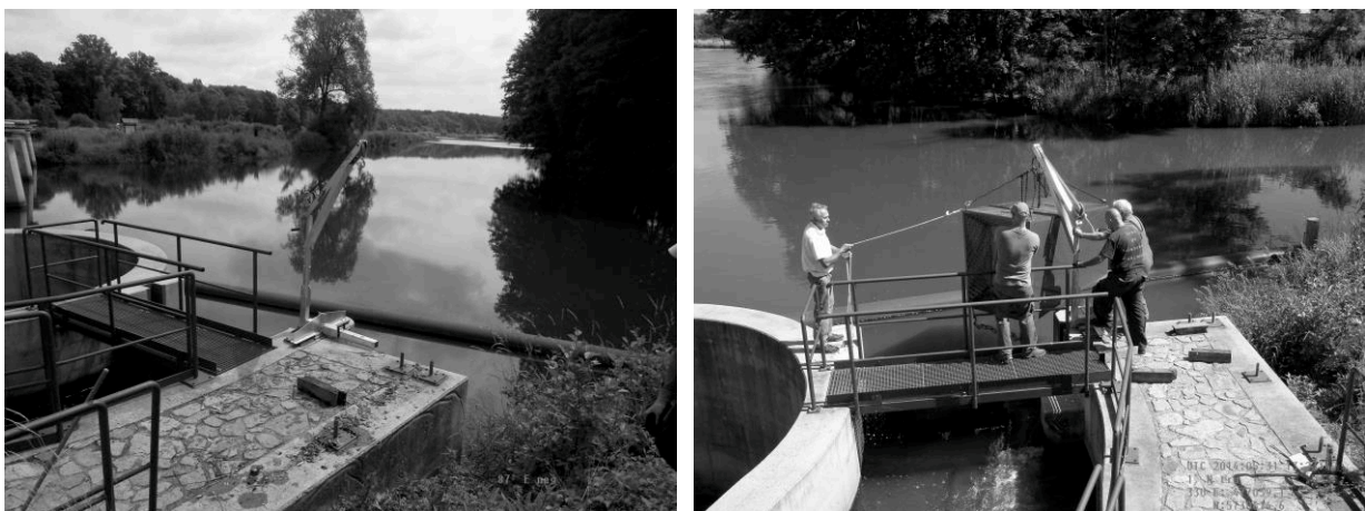
Abbildung 4: Einsatz eines mobilen, tragbaren Krans (18 kg Gewicht bei gleichzeitig 400 kg Zuglast) zum Setzen und Heben der Reuse an der in Abbildung 3 dargestellten Anlage
