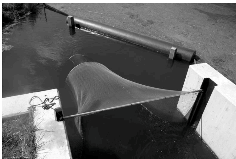
Abbildung 6: Netzreuse, die über einen Metallrahmen in den Notverschlüsse fixiert wird
