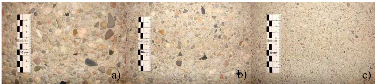
Abbildung 5: Beispiele der untersuchten Oberflächen, a) Rt = 2 mm, b) Rt = 1 mm, c) Rt = 0,3 mm
