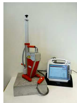
Abbildung 7: Untersuchung der Wiederholgenauigkeit von Sandflächenverfahren und laserbasierter Rauigkeitsmessung
