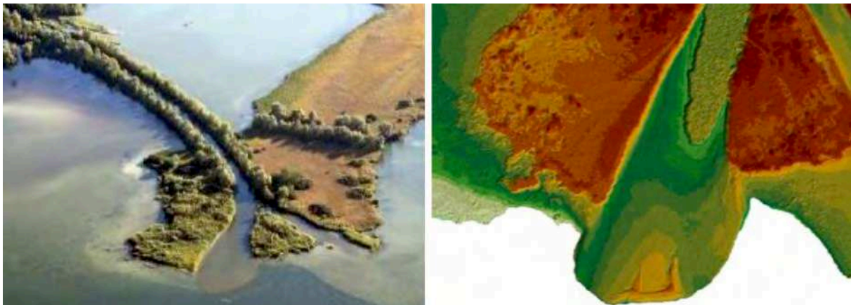
Abbildung 5: Flussdelta – Datenerhebung mit Airborne Hydromapping ohne direkten Zugang in das geschützte Ökosystem (links: Foto, rechts: AHM-Höhenprofil)
