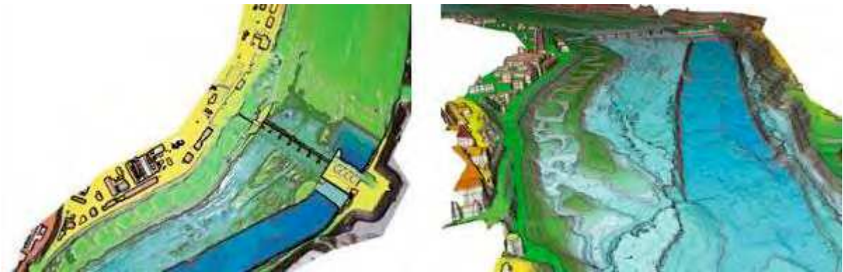
Abbildung 3: Die Wasserkraftanlage Rheinfelden, Datensatz aus miteinander verschnittenen Befliegungs- und Echolotdaten
