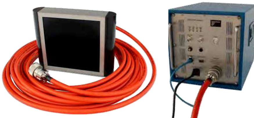
Abbildung 1: Sonde (links) und Transmitter (rechts) des Sedimentecholots
