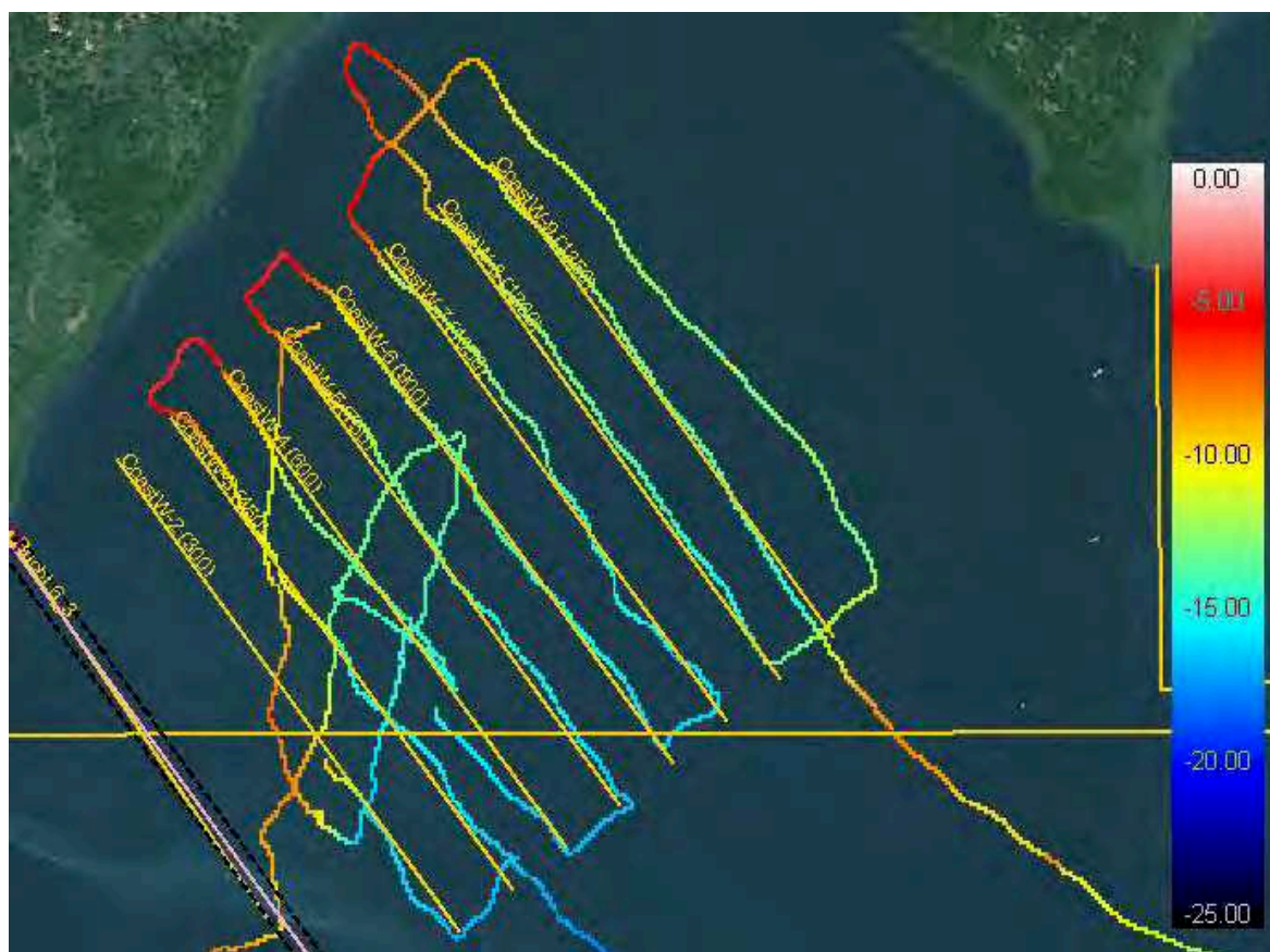
Abbildung 2: Beispiel einer Messung: geplante Messprofile als linienhaftes Raster und tatsächlich gefahrene Messstrecken einschließlich quer liegender Probefahrten
