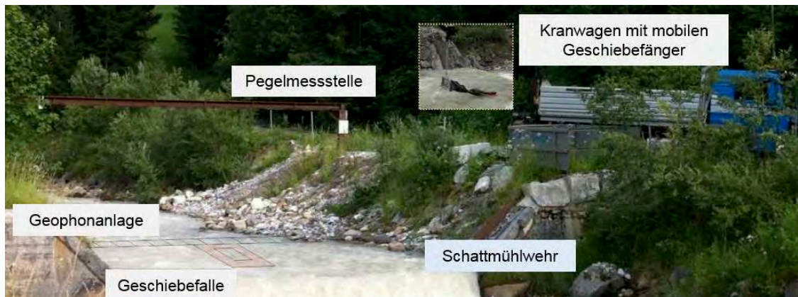
Abbildung 3: Anordnung der Messgeräte im integrativen Geschiebemesssystem Urslau (adaptierte Darstellung aus Kreisler et al., 2014)
