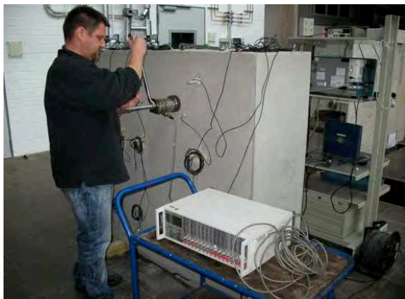
Abbildung 8: Links: Ultraschallsensoren zur baubegleitenden oder nachträglichen Instrumentierung von Betonkonstruktionen. Rechts: Nachträglich installiertes Sensornetzwerk samt Mess- und Übertragungstechnik an einer Brücke in der Türkei (aus: Wolf et al. 2014)
