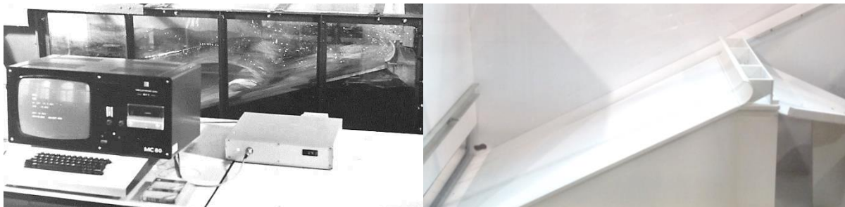
Abbildung 7: Links: Wellenauf- und Überlaufversuche mit Wellenumlenkern (hier Sturzbrecher auf einer 1:3 geneigten glatten Böschung) TU Dresden 1987. Rechts: Versuchsstand zum Wellenauf- und Überlauf mit Wellenumlenker TU Dresden 2017. Bildquelle Pohl
