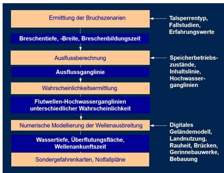
Abbildung 5: Modellierung eines hypothetischen Stauanlagenbruchs und seiner Folgen (Pohl 2008)
