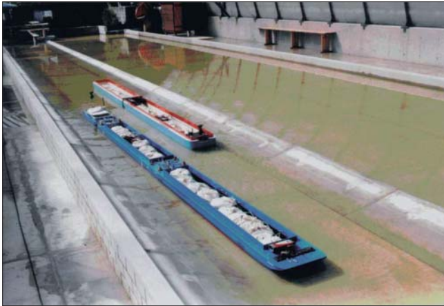
Bild 5: Begegnungsfahrt zweier Schubverbände im Standard-Trapez-Profil
