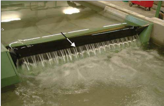
Bild 11: Foto des Schlauchwehrs (vor Einbau der Messtechnik)
