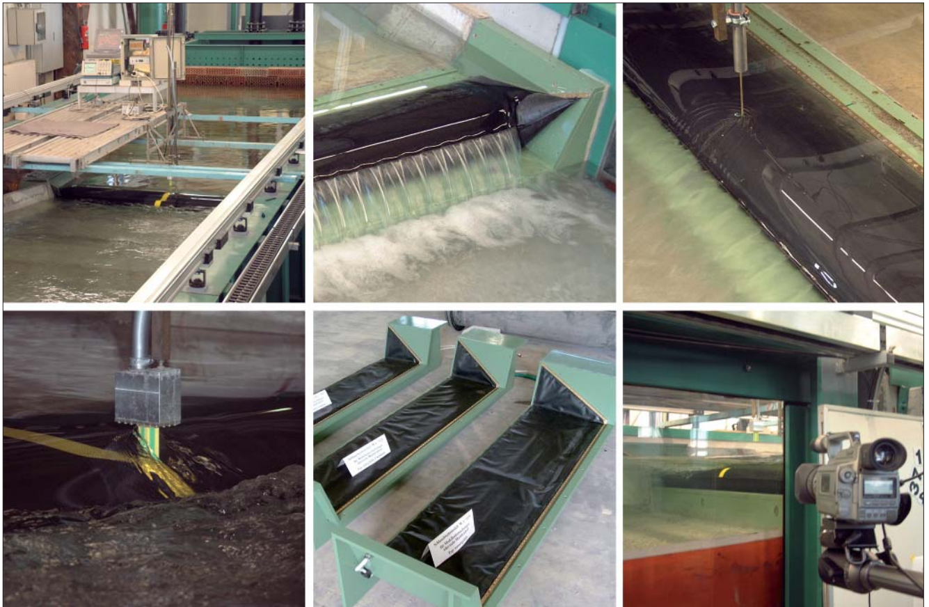
Bild 2: Vollmodell im Maßstab ca. 1:13: oben links) Blick vom Unterwasser, oben Mitte) wassergefülltes Modell mit Fin, oben rechts) induktiver Wegaufnehmer für Geometriemessungen, unten links) Triangulationslaser zur Messung der Vertikalamplituden, unten Mitte) verschiedene Schlauchverschlüsse, unten rechts) Videodokumentation
