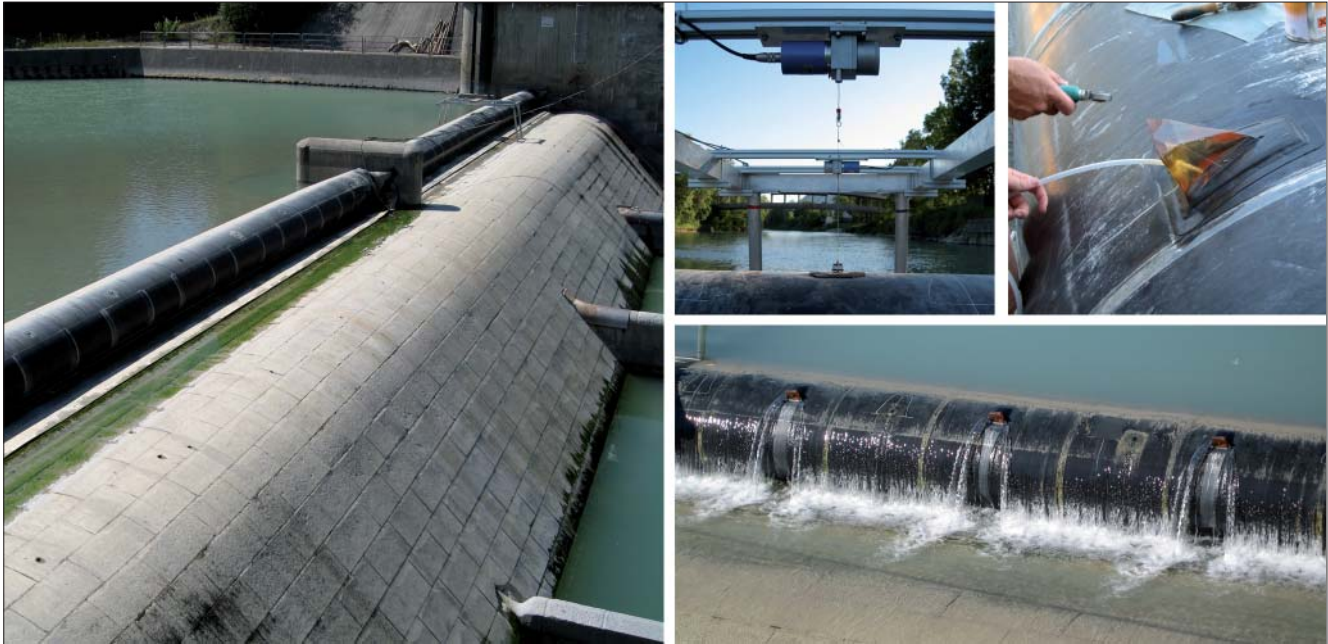
Bild 4: In-situ Messungen am Zollhauserwehr an der Saalach: links) Messgestell im linken Wehrfeld, oben Mitte) Seilzugaufnahme, oben rechts) Montage der Störkörper, unten rechts) Störkörper im Abstand von 2,0 m
