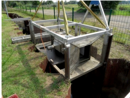
Abb. 4: Vaki-Counter im gehobenen Zustand (Foto: Mockenhaupt, BfG)
