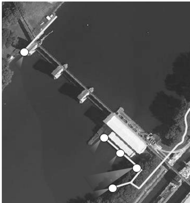
Abb. 2: Prinzipskizze für die Anordnung mehrerer Einstiege und einer zweiten FAA am Beispiel eines Luftbildes der Stauanlage Eddersheim (Luftbild: Bundesamt für Kartographie und Geodäsie)
