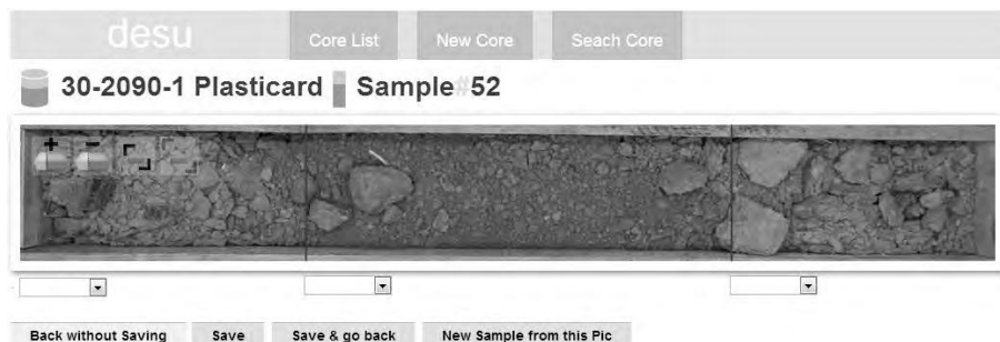
Abbildung 10: Analysesoftware mit freigestelltem Bohrkern und eingezeichneten Schichtgrenzen
