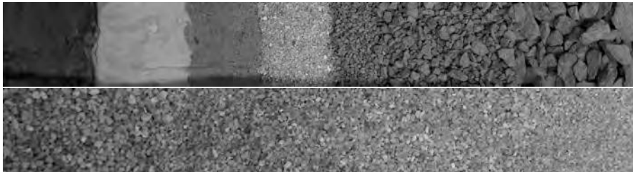
Abbildung 9: Testbeispiele von Kernkisten mit deutlichen und nahezu stufenlosen Übergängen zwischen den Schichten
