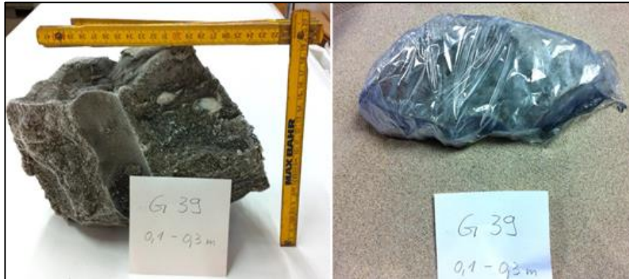
Abbildung 5: Gefrorene Sedimentpakete werden für die Durchführung von Permeameterversuchen aufbereitet.
