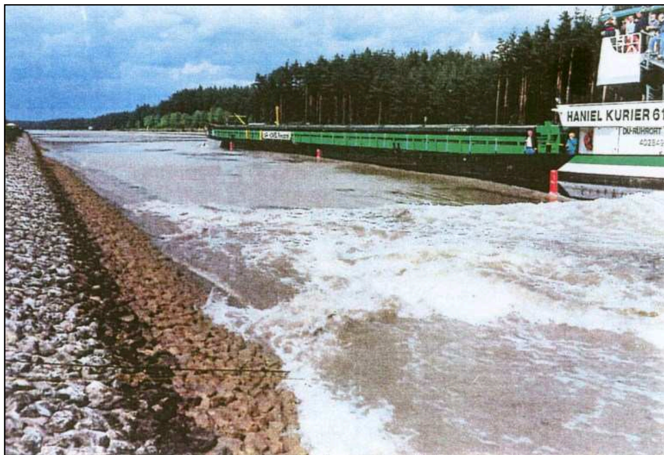
Bild 5: Fahrt des Haniel Kurier 61 mit kritischer Schiffsgeschwindigkeit im Main-Donau-Kanal im Rahmen der von BAW und DST fachlich begleiteten Versuche vor Eröffnung des Kanals zur fahrdynamischen Gleichwertigkeit von Rechteck- und Trapezprofil
