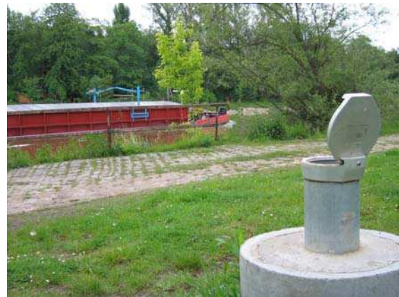
Bild 1: Geöffnete Grundwasser-Messstelle an einer Bundeswasserstraße
