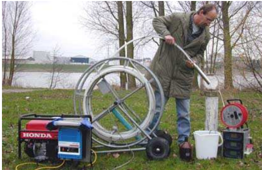
Bild 2: Qualifizierte Grundwasser-Probenahme mittels Unterwassermotorpumpe (U-Pumpe)
