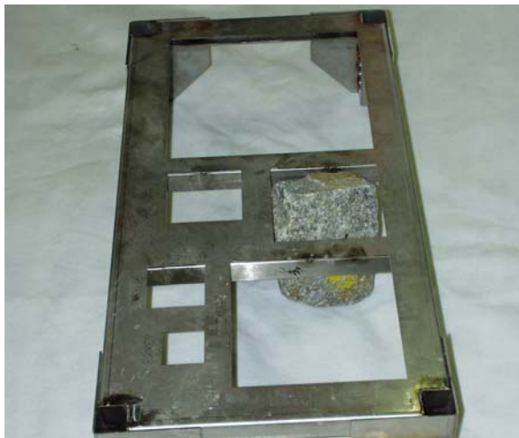
Bild 2: Größenermittlung D über ein Quadratlochsieb
