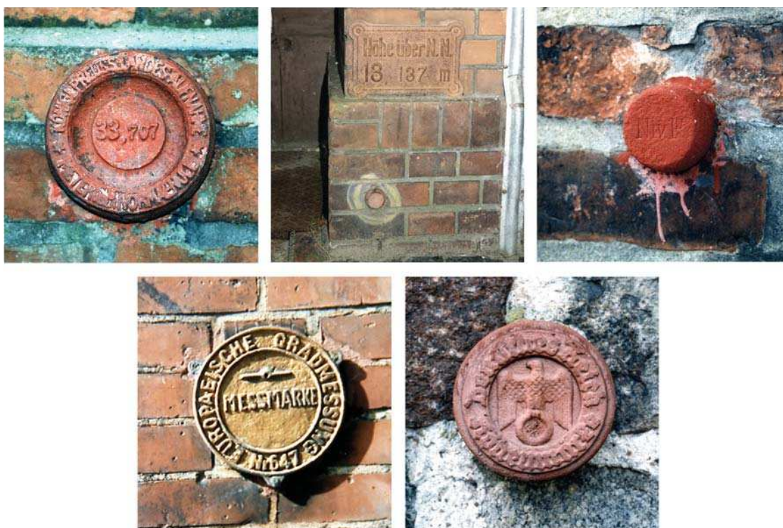
Abb. 5: Beispiele für erhaltene Vermarkungen von Nivellements Punkten früherer Höhennetze. Höhenmarke (oben links) und Mauerbolzen (oben Mitte und rechts) der Trigonometrischen Abteilung der Königlich Preußischen Landesaufnahme, Höhenmarken des Geodätischen Instituts Potsdam (unten links) und des Reichsamtes für Landesaufnahme (unten rechts)
