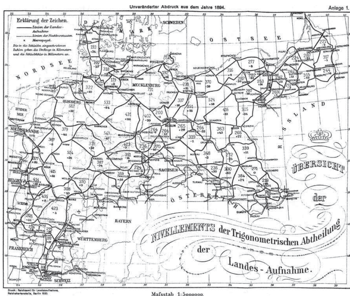
Abb. 1: Verlauf der Nivellementslinien der Trigonometrischen Abteilung der Landesaufnahme Preußens, die in den Jahren 1869–1889 beobachtet wurden (SCHREIBER, 1879)
