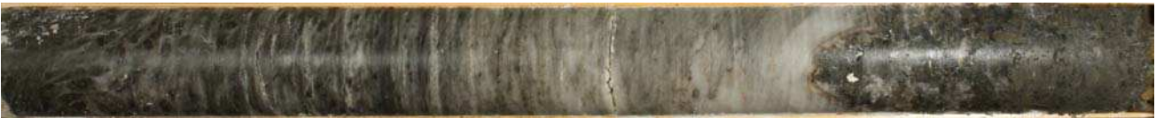
Bild 5: Kompakter Gips der Oberen Sulfatschichten mit Tonsteineinlagerungen
