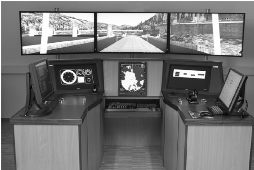
Abb. 6: BAW-Schiffsführungssimulator ANS 5000 am Standort Karlsruhe.
