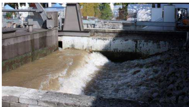
Abb. 7: Wellenanlage und Großschergerät zur Untersuchung alternativer Ufersicherungen (Fotos: BAW)
