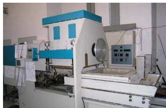
Abb. 7: Wellenanlage und Großschergerät zur Untersuchung alternativer Ufersicherungen (Fotos: BAW)
