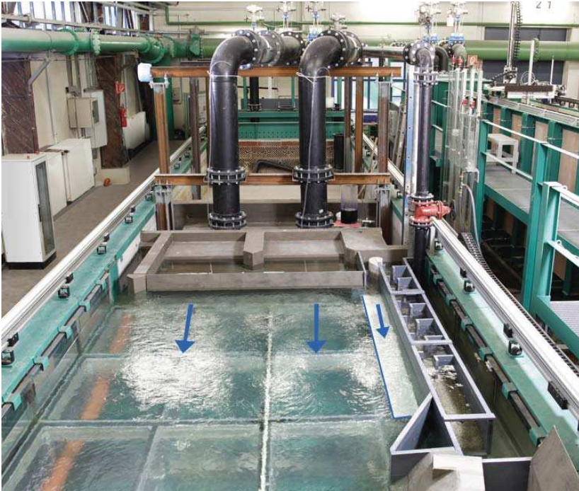
Bild 4: Physikalisches Modell des Unterwassers der Staustufe Lauffen: Blick von unterstrom auf den Kraftwerksauslass, rechts der geplante Einstieg in die Fischaufstiegsanlage.
