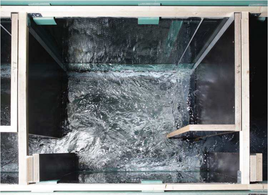
Bild 6: Strömungsfeld in einem Schlitzpass, Blick von oben.
