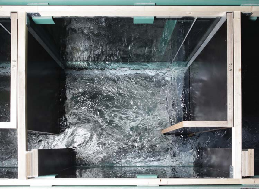
Bild 6: Strömungsfeld in einem Schlitzpass, Blick von oben.
