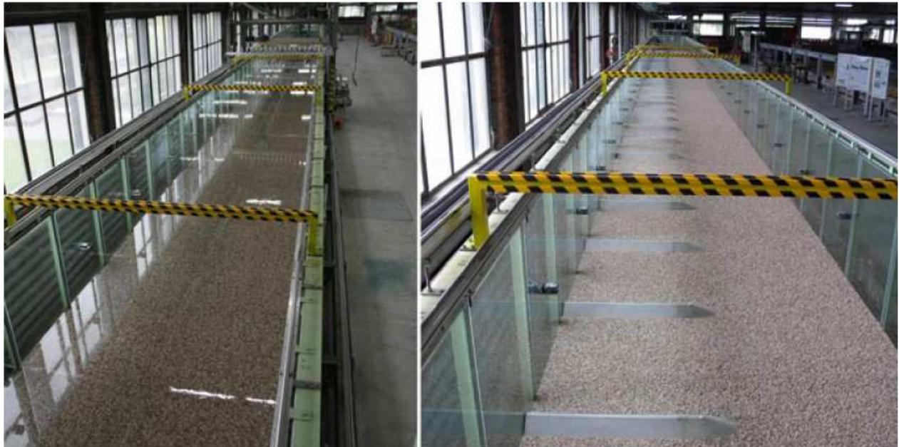
Bild 1: Unverbaute Rinne (links) und Rinne mit Buhneneinbauten (rechts)
