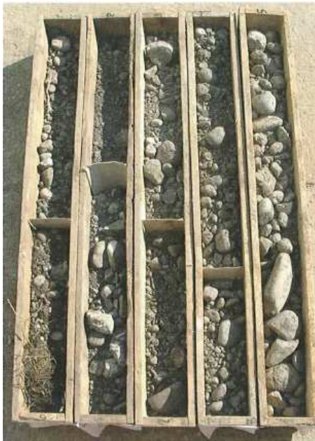
Bild 5: Erkundungsbohrung im Rheinkies.
